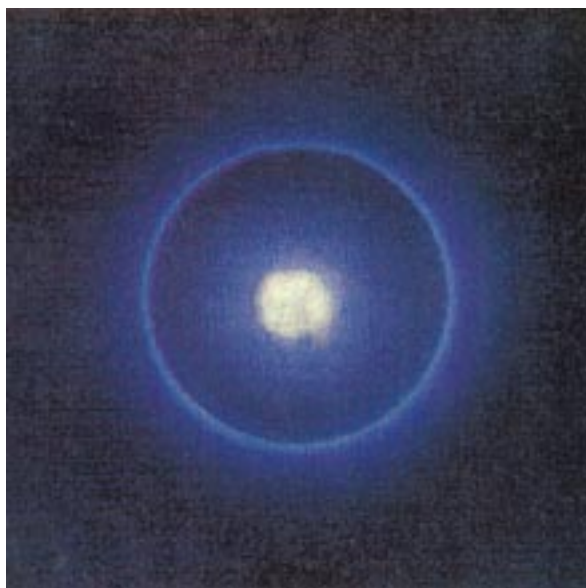
Рис. 5. Фотография кольца черенковского света, излученного в стекле протонами с энергией 660 МэВ.
